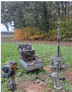
Abb. 5: Rammsondiergerät (RSG) und Geländeraupe mit Bohrequipment ©
