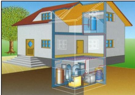
Anlagenschema Variante 1 – Luft/Wasser-Wärmepumpe
